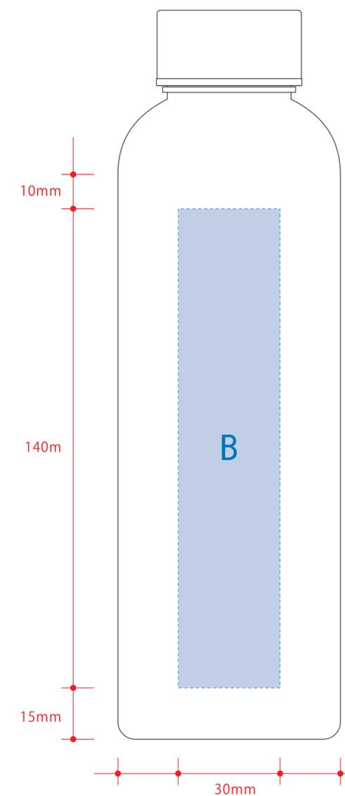
■インクジェット印刷 最大範囲：B / W30×H140(mm)
